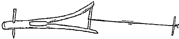
Gambar 12 Bentuk pikeplok dengan tali yang bisa dipanjangkan sesuai wilayah yang dilewatinya
