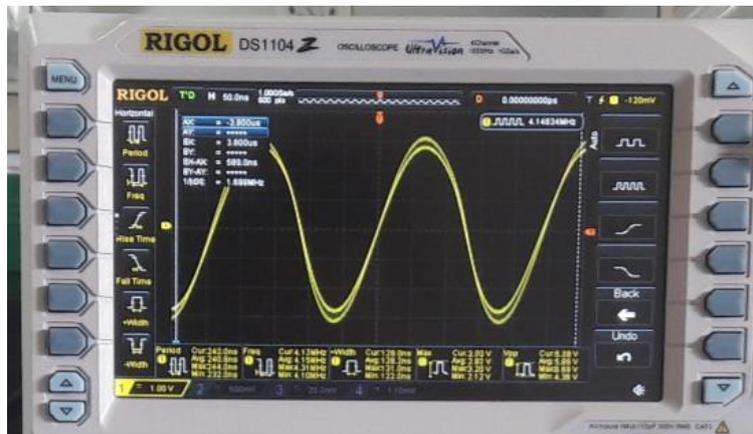
Gambar 4.4 Gelombang sinus Hasil pengukuran nilai frekuensi
