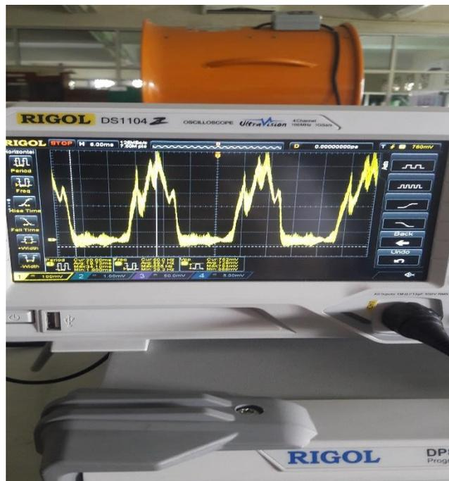
Gambar 4.6 Sinyal rangkaian *receiver* setelah disearahkan
