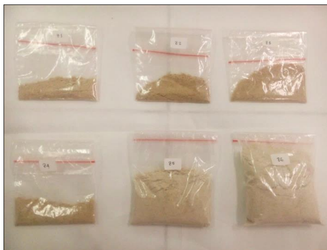
Gambar 3. Sampel beras yang telah berbentuk serbuk ditimbang menggunakan timbangan digital dan diambil \pm 1 gram setiap sampelnya. Sampel tersebut siap untuk didestruksi menggunakan \text{HNO}_3(\text{p}) .
