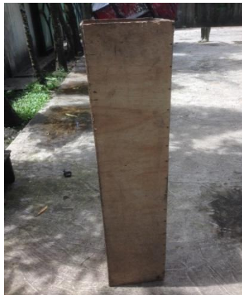
Gambar lampiran 10 kotak sampling 0,2m x 0,2m x 1m (40 L)
