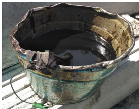
Gambar 5.39 Minyak bekisting dengan menggunakan oli
