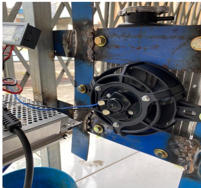
Gambar 3.9 Pemasangan Electric fan
