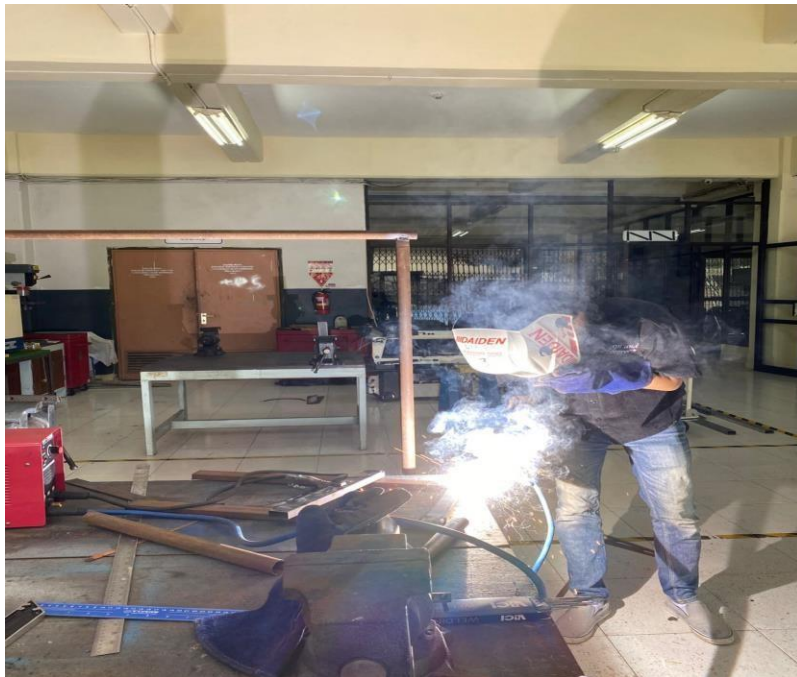
Gambar 3.7 Pembuatan dudukan radiator
