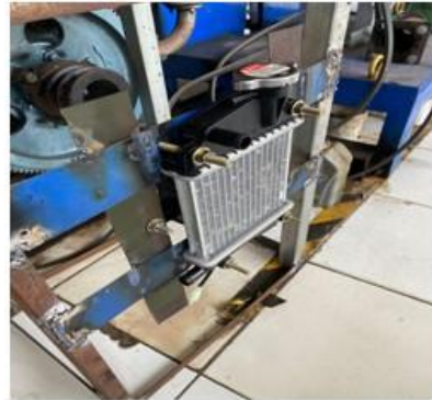
Step 2 Pemasangan radiator
