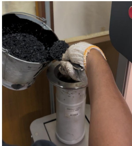
Gambar 4. 3 Proses Memasukkan Benda Uji Kedalam Cetakan Gyratory
