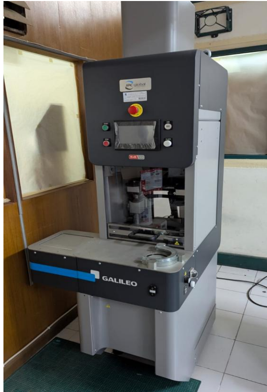
Gambar 3. 3 Pemadatan Gyratory dengan Mesin Galileo di Lab Jalan Raya Universitas Islam Indonesia
