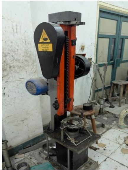
Gambar 3. 2 Pematatan Marshall dengan Impact Hammer di Lab Jalan Raya UII
