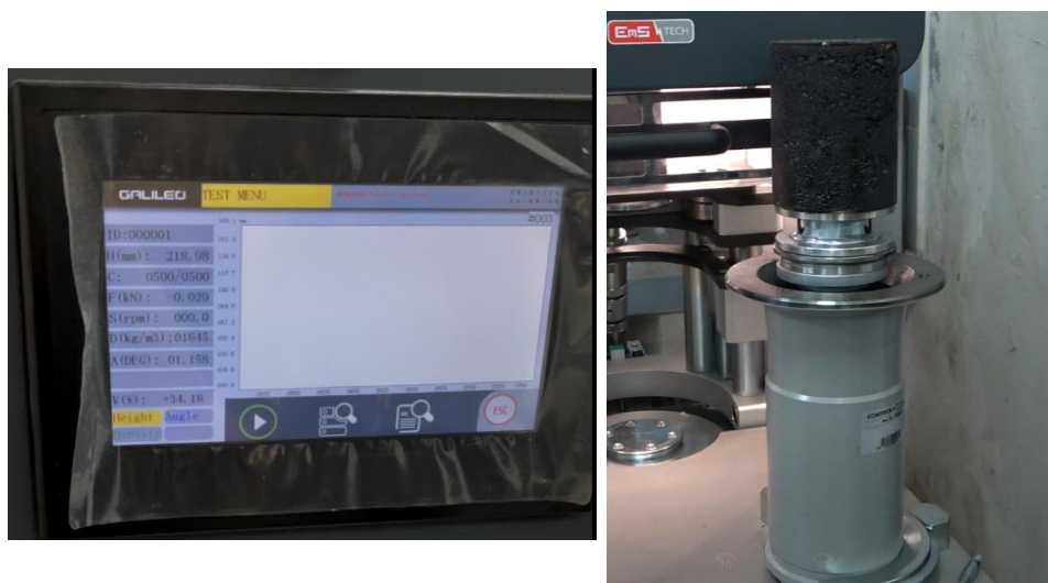
Gambar 4. 5 Proses Pengeluaran Benda Uji Pada Mesin Gyratory
