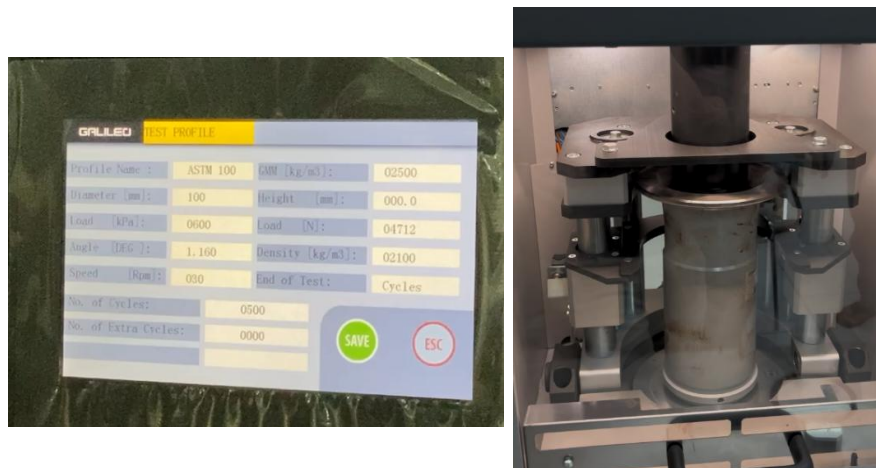
Gambar 4. 4 Proses Pengaturan dan Pemasangan Benda Uji Pada Mesin Gyratory
