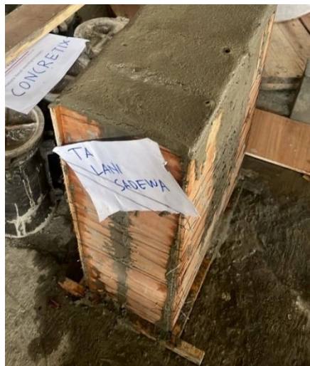
Gambar 4. 10 Proses Pembuatan Bata Ringan
