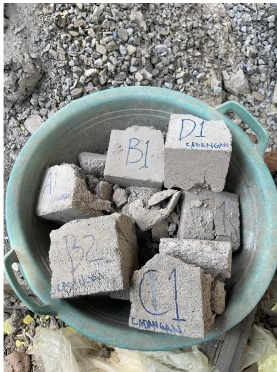
Gambar L 6. 2 Bata Ringan Setelah Uji Kuat Tekan
