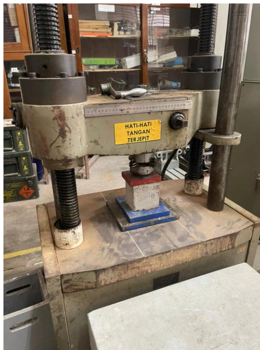
Gambar 4. 12 Pengujian Kuat Tekan Beton
