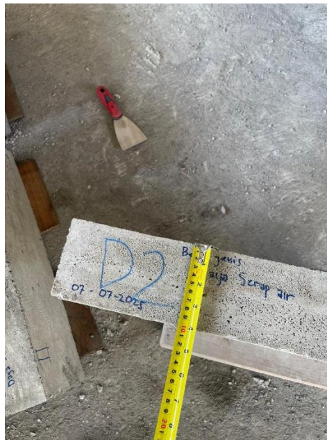
Gambar 4. 13 Pengujian Berat volume Beton
