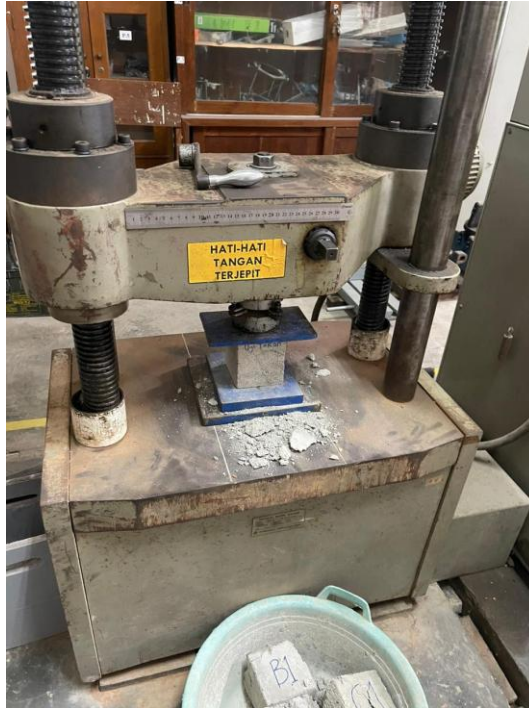
Gambar L 6. 1 Pengujian Kuat Tekan
