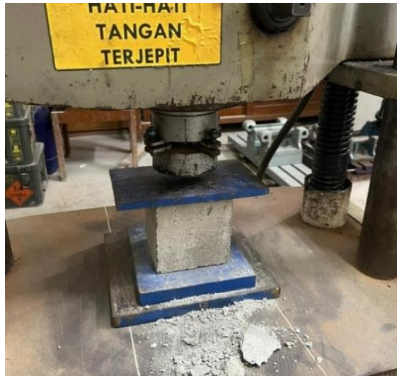
Gambar 5. 2 Setting Up Bata Ringan Untuk Uji Kuat Tekan
