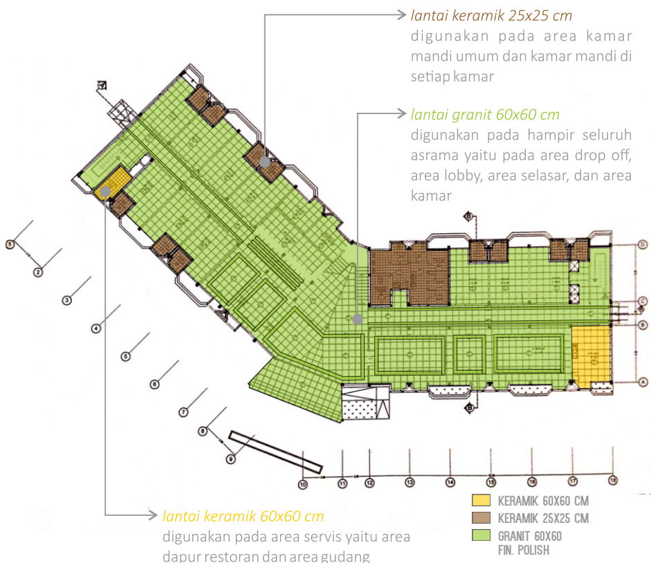
Rencana pola lantai 1 pada Asrama MMTC Blok III Yogyakarta sumber: PT. Arsigraphi, 2017
