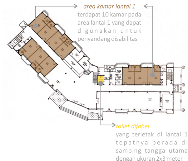
Denah akhir pada Asrama MMTC Blok III Yogyakarta sumber: PT. Arsigrapi, 2017
