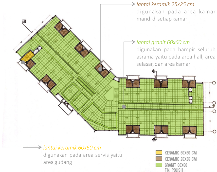
Rencana pola lantai tipikal pada Asrama MMTC Blok III Yogyakarta sumber: PT. Arsigraphi, 2017
