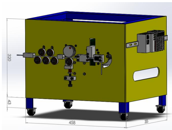
Gambar 4. 1 Desain Mesin CNC Pembuat Cincin Begel
