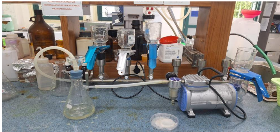
Gambar 3. 5 Proses Penyaringan Menggunakan Kertas 300 Mesh
