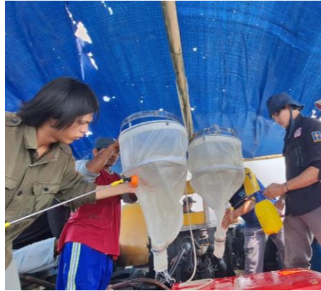
Gambar 3. 1 Proses Pembilasan Bongo Net
