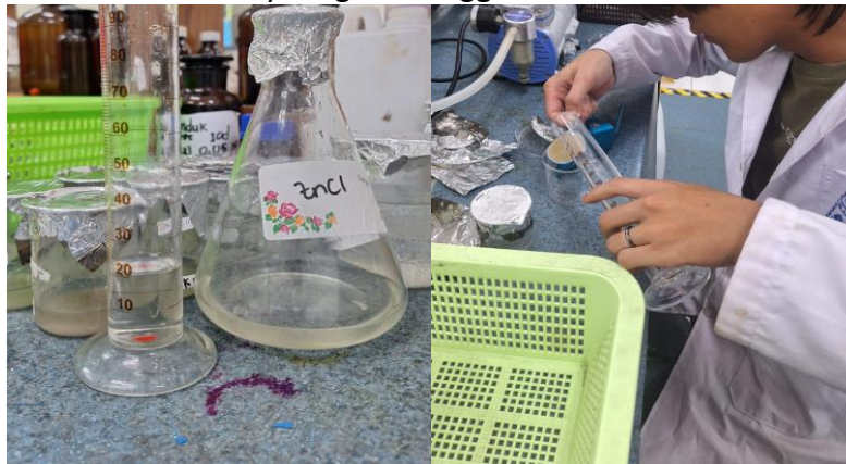
Gambar 3. 6 Proses Penambahan ZnCl_2 Pada Sampel
