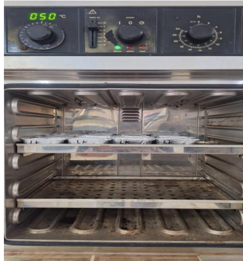
Gambar 3. 8 Proses Pengeringan Sampel Menggunakan Oven
