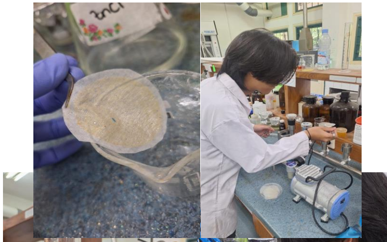
Gambar 3. 7 Proses Penyaringan Menggunakan Kertas Whatman
