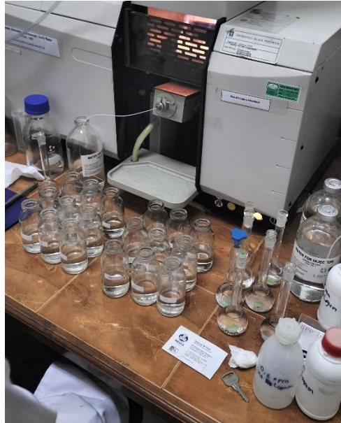
Pembacaan logam Natrium dan Kalsium menggunakan AAS
