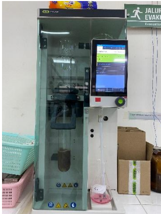
Proses destilasi sampel
