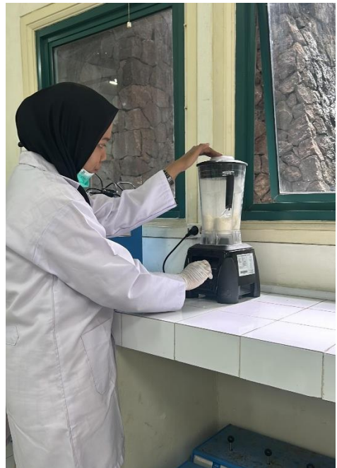
d). Adsorben kulit durian di blender setelah itu diayak dengan 50 mesh
