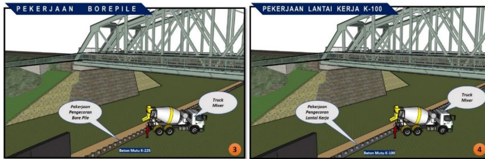
Gambar 5. 5 Ilustrasi Pekerjaan Pengecoran Borepile dan Lantai Kerja
