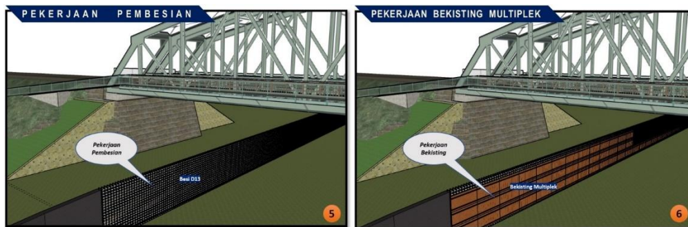
Gambar 5. 6 Ilustrasi Pekerjaan Pembesian dan Pek. Bekisting
