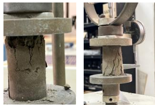
Hasil Pengujian Kuat Tekan Bebas Tanah Asli + Semen 3% & Gypsum 5% Pemeraman 1 Hari
