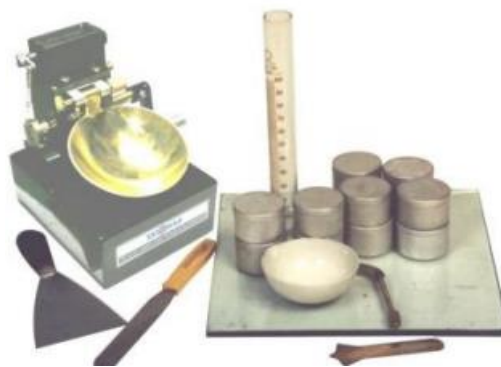
Gambar 3.3 Peralatan Pengujian Atterberg
