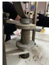
Hasil Pengujian Kuat Tekan Bebas Tanah Asli + Semen 3% & Gypsum 1% Pemeraman 3 Hari
