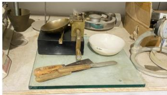
Gambar 4.3 Peralatan Pengujian Atterberg
