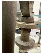
Hasil Pengujian Kuat Tekan Bebas Tanah Asli + Semen 3% & Gypsum 1% Pemeraman 3 Hari
