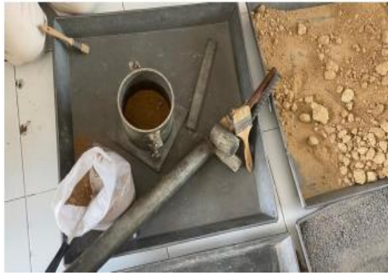
Gambar 4.5 Peralatan Pengujian Proktor
