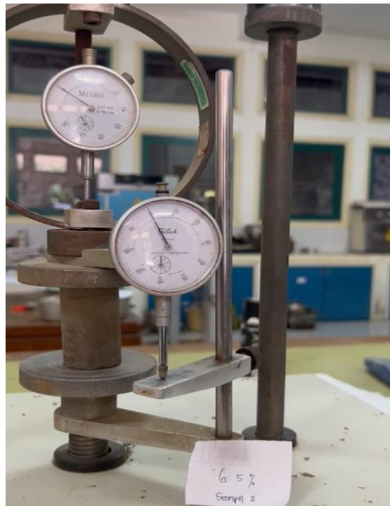
Gambar 4.6 Peralatan Pengujian Kuat Tekan Bebas
