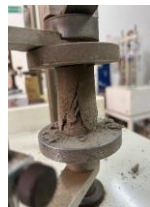
Hasil Pengujian Kuat Tekan Bebas Tanah Asli + Gypsum 3% Pemeraman 1 Hari
