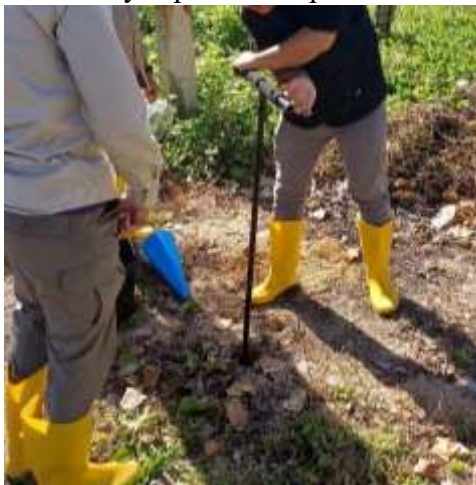
Pengambilan sampel tanah menggunakan mud auger
