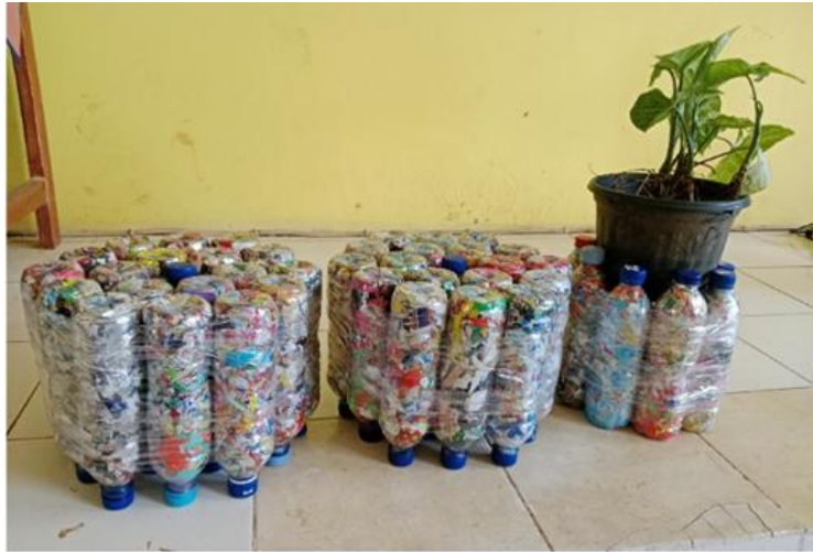
Gambar 4. 41 Pengolahan sampah anorganik dengan Ecobrick
