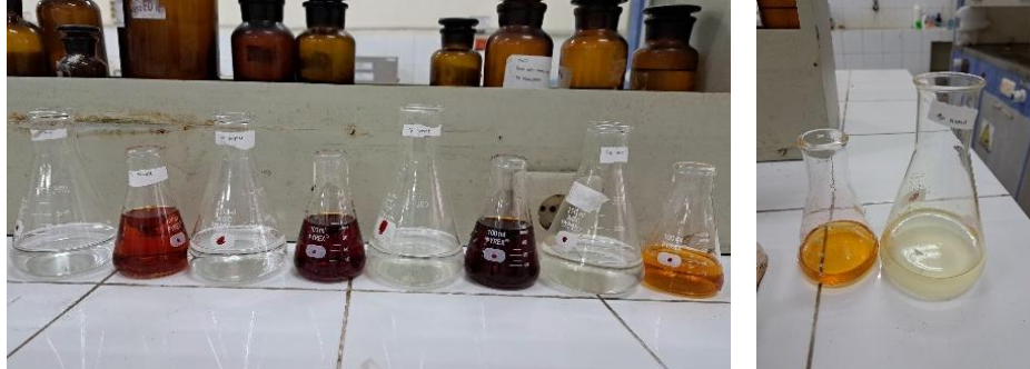
Proses perhitungan dosis ozon dengan titrasi iodometri
