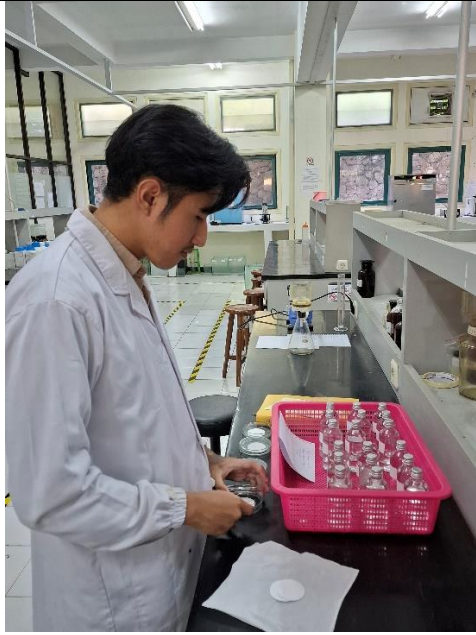
Penyaringan Sampel dengan Kertas Saring dan Vacum Pump
