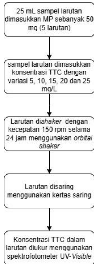
Gambar 8: Diagram alir percobaan adsorpsi dengan variasi konsentrasi tetracycline .
