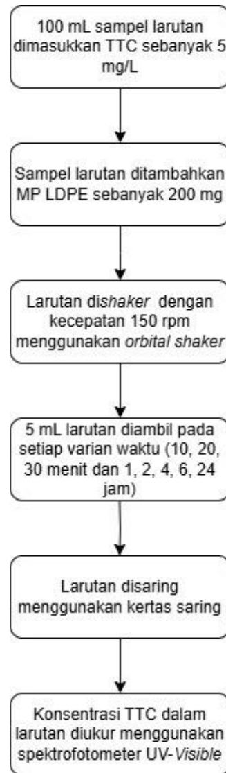
Gambar 9: Diagram alir percobaan adsorpsi dengan variasi waktu kontak.
