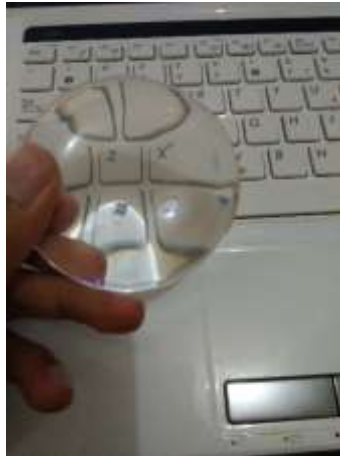
Gambar 4-35 Pembesaran Yang Dihasilkan Lensa Polimer Desain Master Lensa 1
