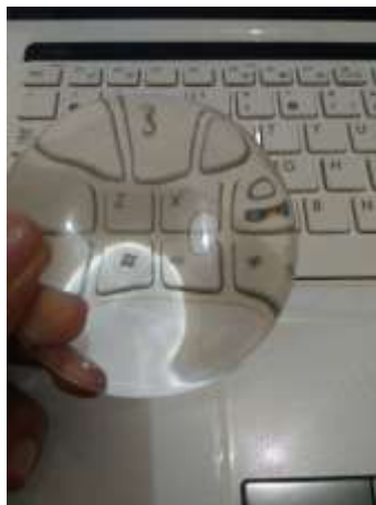
Gambar 4-36 Pembesaran Yang Dihasilkan Lensa Polimer Desain Master Lensa 2
