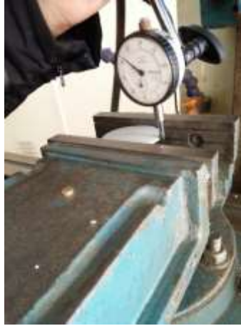
Gambar 4-28 Proses Pengukuran Kelengkungan Master Lensa
