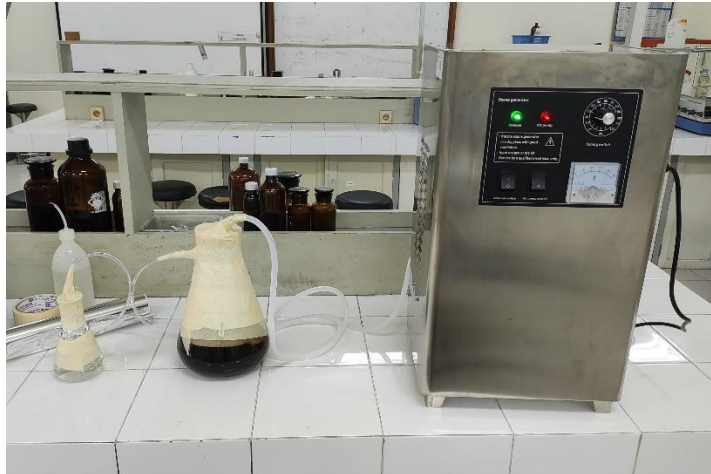
Gambar 3.7 Instalasi Reaktor AOP pada Air Lindi
