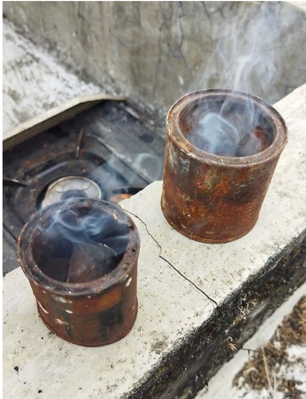
Gambar 3.6 Uji Nyala dan Ketahanan Briket
