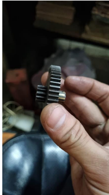
Gambar 4-12 Hasil Pembuatan Gear Middle
