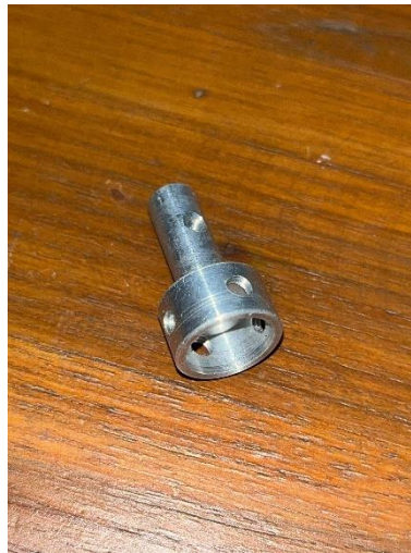
Gambar 4-18 Coupling dengan Empat Baut Pengunci
