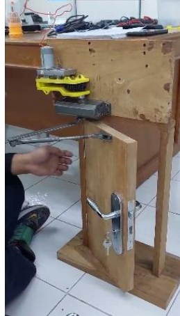
Gambar 4-15 Pengujian Mekanisme Penggerak Door Closer pada Pintu Prototipe
