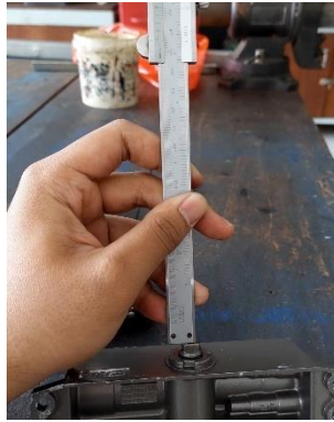
Gambar 3-3 Pengukuran Tebal Poros Door Closer
