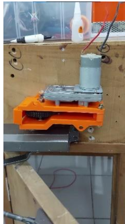
Gambar 4-16 Pengujian Keseluruhan Mekanisme Penggerak Door Closer
