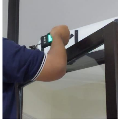
Gambar 3-2 Pengukuran Gaya Door Closer
