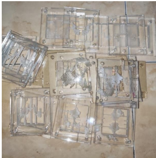
Gambar 4. 11 Pemesinan Garuda yang Tidak Berhasil
