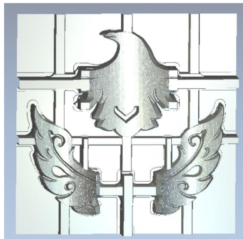
Gambar 3. 17 Hasil Simulasi Pemesinan Atas Garuda Relief
