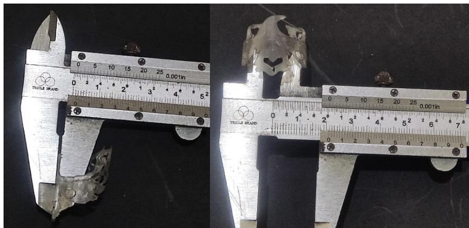
Gambar 4. 10 Hasil Pengukuran Master Cincin Garuda Relief
