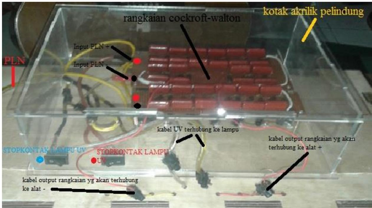
Gambar 3.9 Bagian luar rangkaian pembangkit tegangan tinggi
