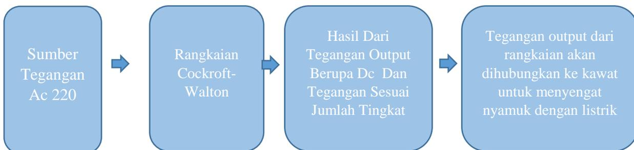
Gambar 3.1 Blok diagram sistem pembangkitan tegangan tinggi DC
