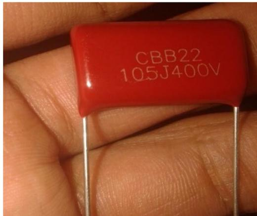
Gambar 3.3 Kapasitor myllar  $1\mu\text{F}$ /400 volt
