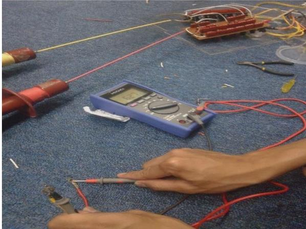
Pengukuran tegangan output pada pembangkit
