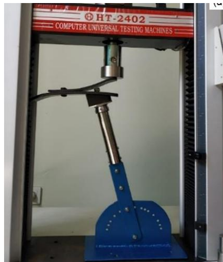
Gambar 2.2. Compressive test menggunakan HT-2402 [4].
