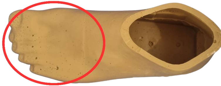
Gambar 4.25. Void pada produk cover prostetik ESAR .
