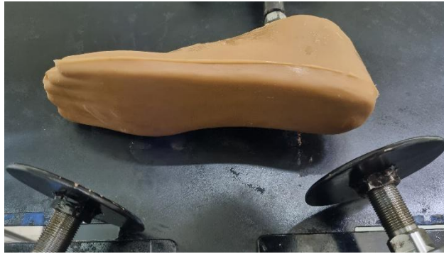
Gambar 4.24. Pengujian preliminary fatigue setelah 100.000 siklus.
