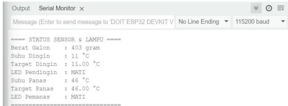
Gambar 4.16 Hasil Uji Sensor Suhu Dingin dan Status Pendingin
