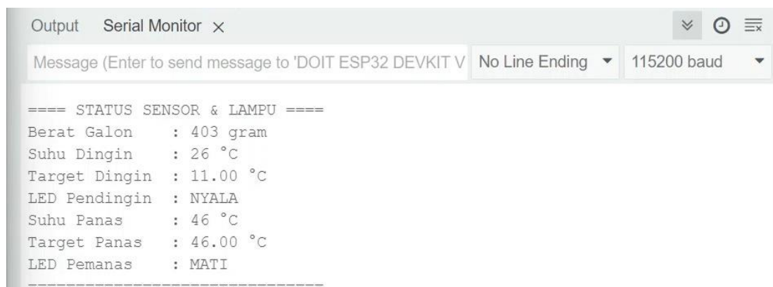
Gambar 4.19 Hasil Uji Sensor Suhu Panas dan Status Pemanas
