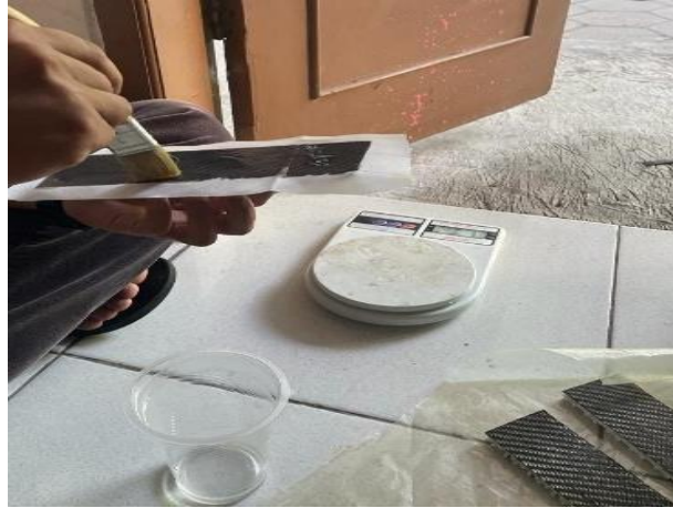
Gambar 3-27 Proses Hand Lay Up Menggunakan Resin
