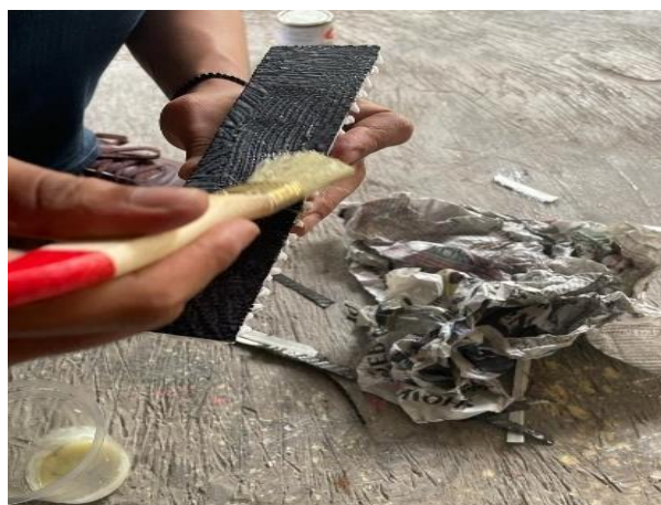
Gambar 3-26 Proses Hand Lay Up Menggunakan Lem ALF
