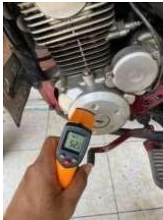
Gambar 4.18 Pengecekan suhu panas sebelum dipasang cover mesin
