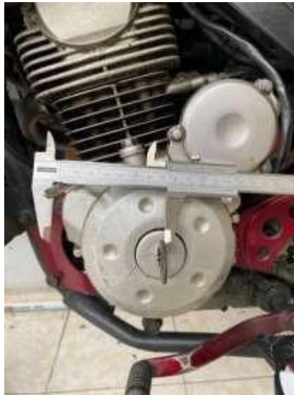
Gambar 4.1 Pengukuran dimensi menggunakan jangka sorong
