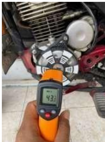
Gambar 4.19 bak mesin setelah dipasang cover mesin
