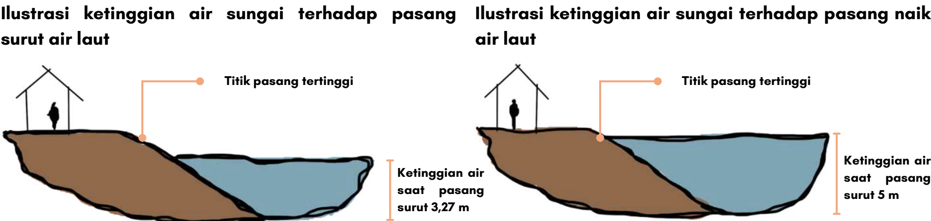
Gambar x.x. Ilustrasi selisih tinggi permukaan air sungai dan tapak Sumber : Penulis, 2024
