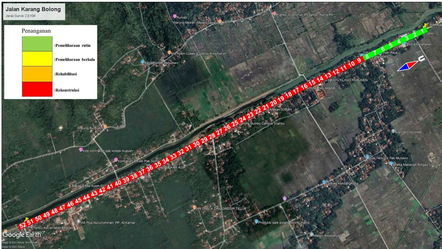
Gambar 5. 12 Penanganan Perbaikan ruas Jalan Karang Bolong KM 5.750-8.350
