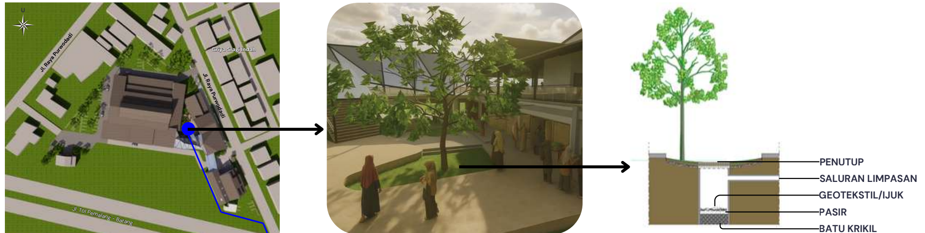
Gambar 4.22 Skema Konsep Drainase Pasar Sragi (Sumber: Dokumentasi Penulis)
