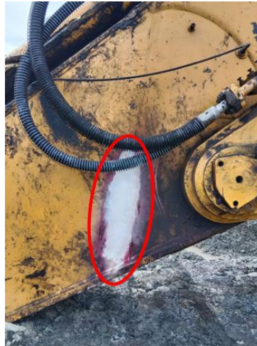
Gambar 4-90 Retakan di sambungan las pada arm (Sumber: Tim Fabrikasi Site RANT)
