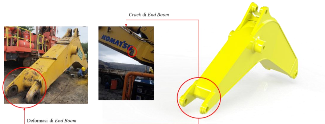
Gambar 1-3 Permasalahan pada komponen boom (Sumber: Dokumentasi Tim Fabrikasi KPP Site RANT)
