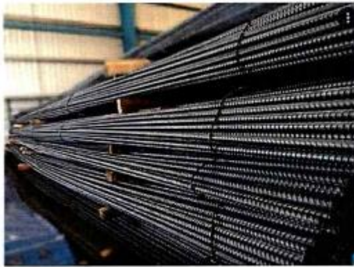
Gambar 3.7 Material besi BJTS 420B (Sumber: PT ADHI-JMTM KSO, 2025)
