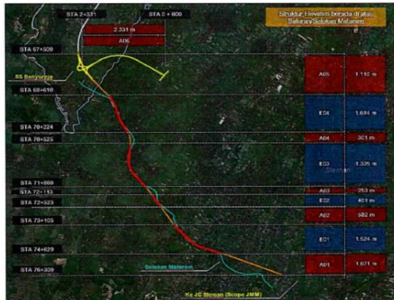
Gambar 3.3 Layout Lokasi Pekerjaan Jalan Tol Seksi 1
