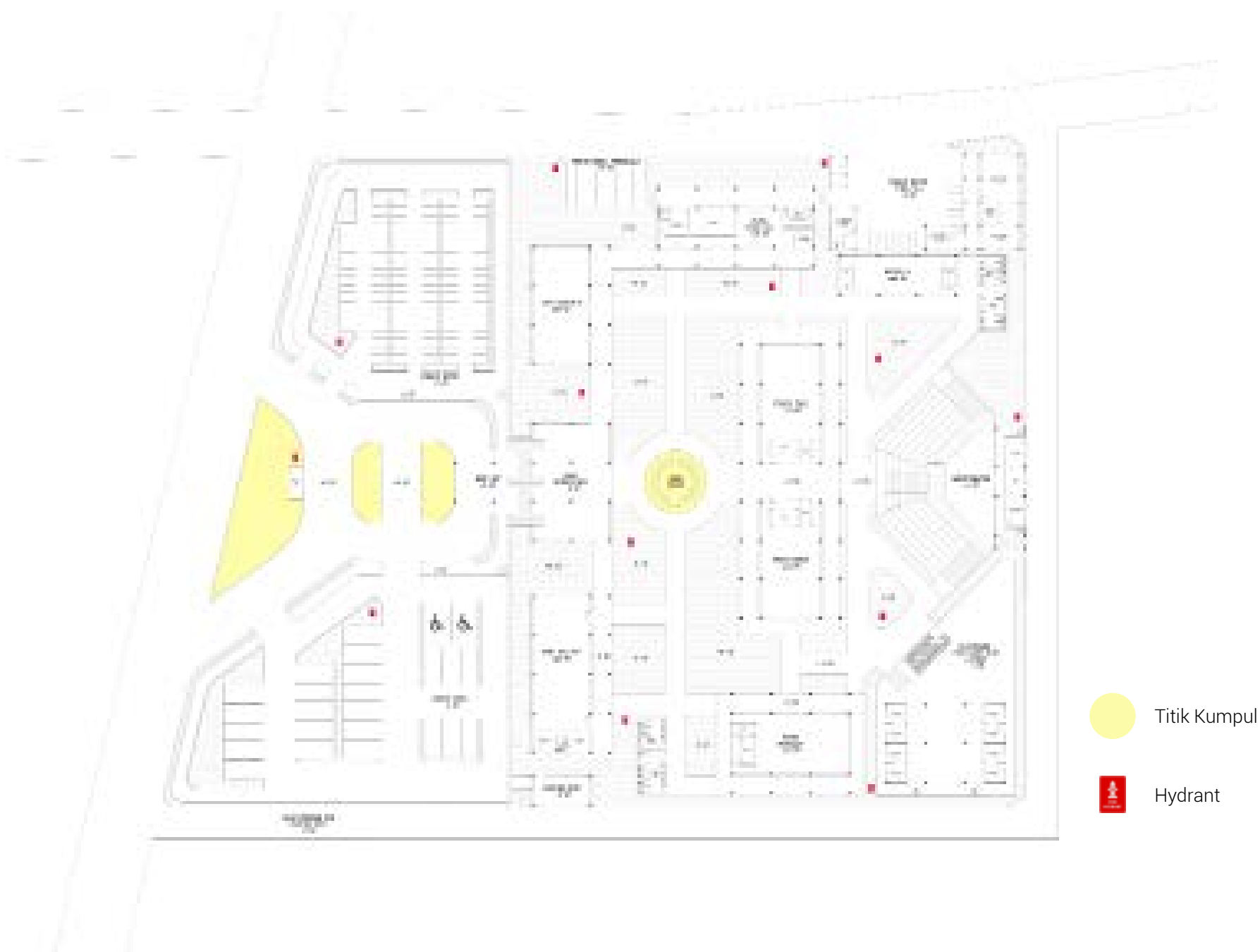
Gambar 4.24 Rencana Sistem Keselamatan Bangunan Sumber: Penulis, 2025
