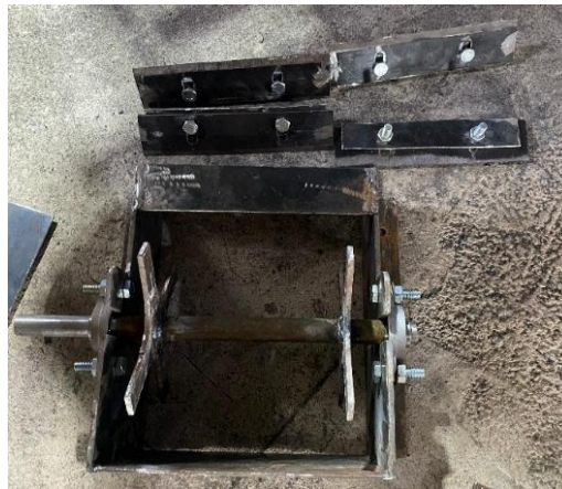
Gambar 4-14 Proses penyatuan komponen pisau
