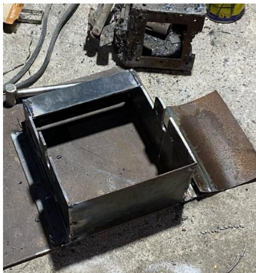
Gambar 4-11 Hasil pembuatan bodi bawah
