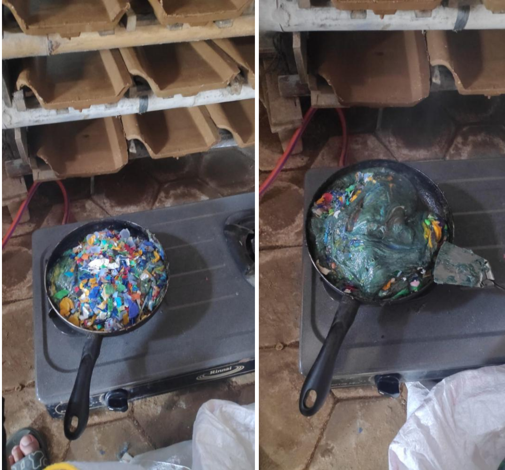
Gambar 1. Proses Pembuatan Genteng Komposit di Godean
