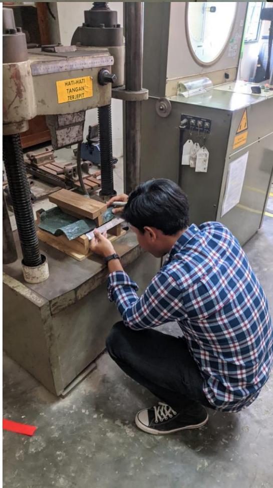
Dokumentasi 6. Pengujian Tekan di Laboratorium UII
