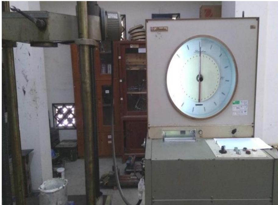
Gambar 4.15 Alat Uji Lentur Mesin UTM Sumber: Penulis, 2024
