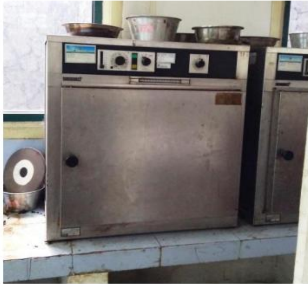
Gambar 4.16 Oven untuk Uji Daya Serap Air Dokumentasi Peneliti, 2025
