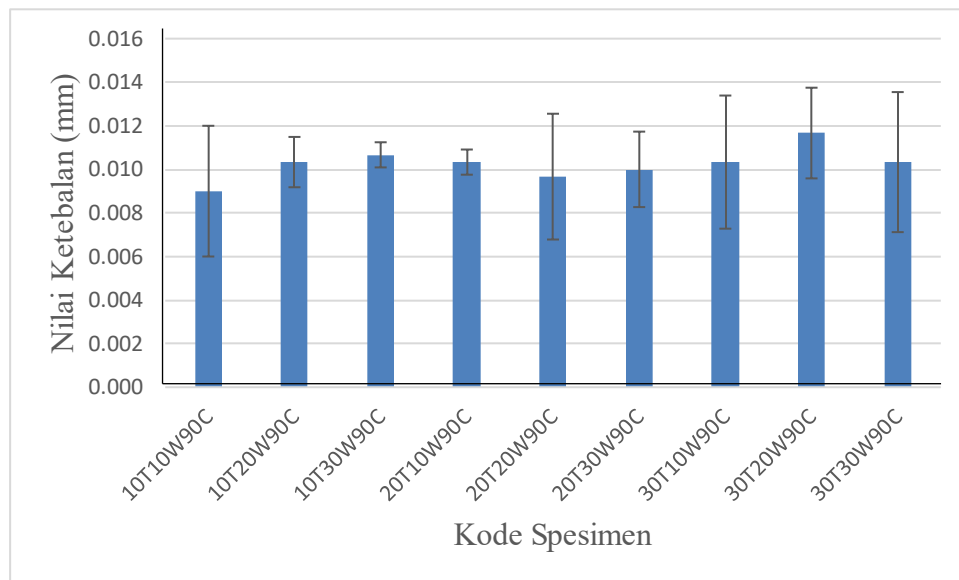
Gambar 4- 15 Grafik Pengujian Ketebalan Permukaan
