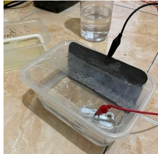
Gambar 4- 16 Proses Pengaplikasian Anodizing Pada Produk
