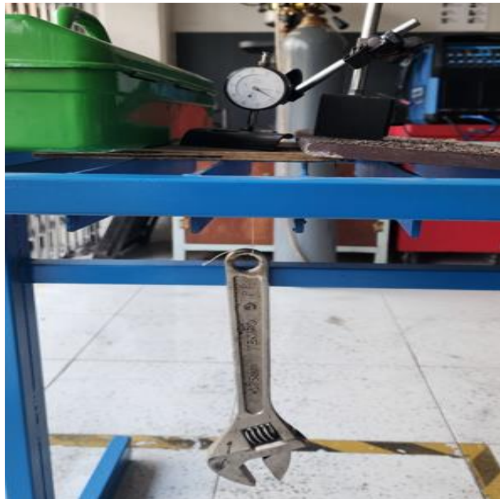
Gambar 3-24 Proses pengujian defleksi
