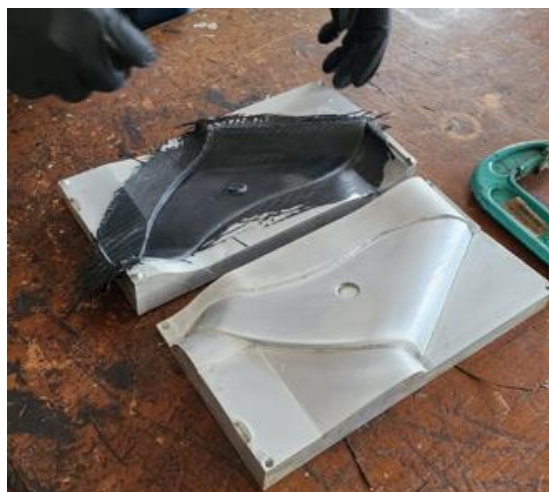
Gambar 3-11 Proses demolding produk
