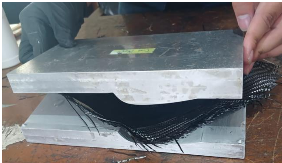
Gambar 3-8 Proses penutupan cetakan
