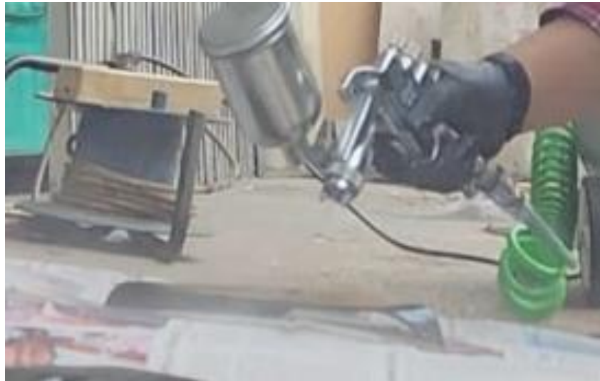
Gambar 3-15 Pelapisan mix clear coat
