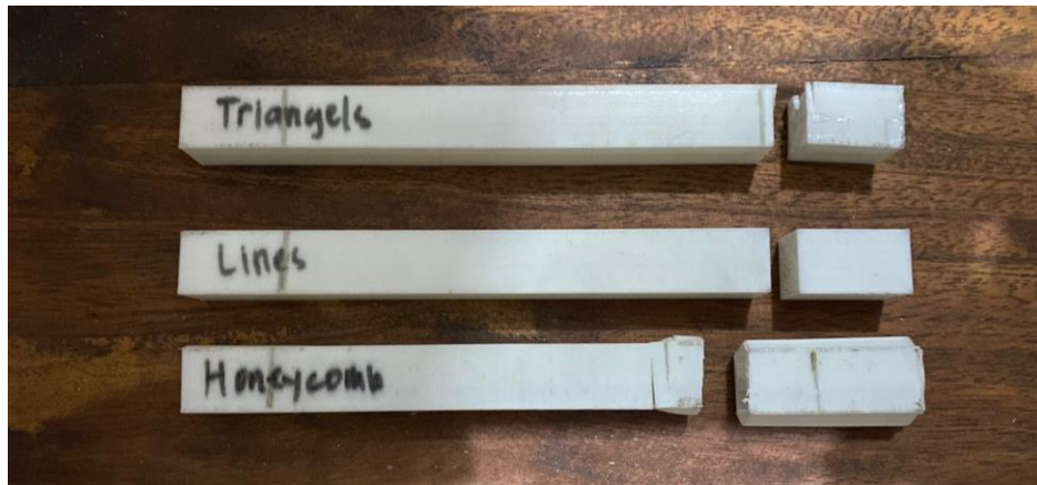
Gambar 4- 5 Spesimen Hasil Pengujian Tarik
