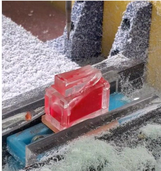
Gambar 4 - 2 Penarikan mata pahat dari Jig sebab tergesernya benda kerja
