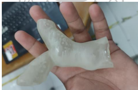
Gambar 2 - 2 Hasil prototipe bahan resin SLA
