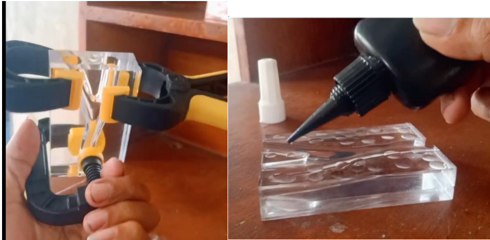
Gambar 4 - 16 Proses perekatan dengan lem
