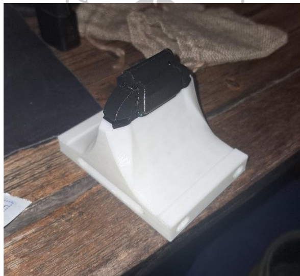
Gambar 3 - 14 Hasil pembuatan kontur amplas dengan 3D print
