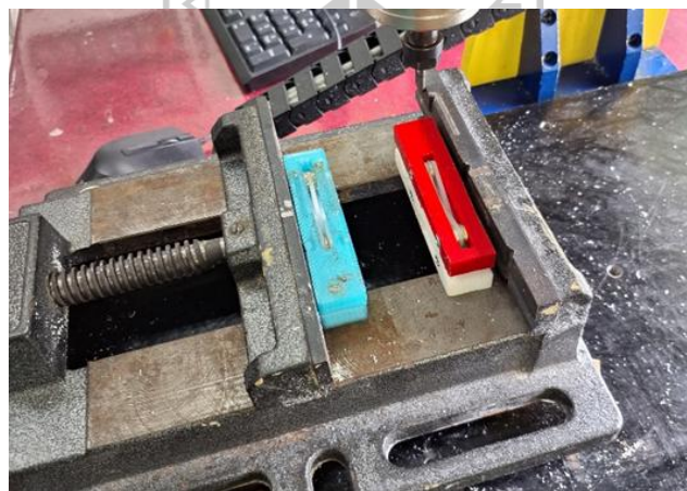
Gambar 3 - 10 Penggunaan Height adjustment base pada ragum untuk permesinan
