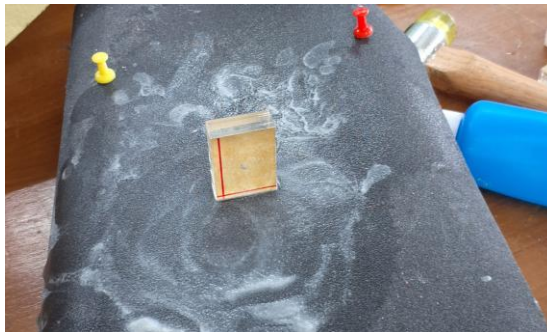
Gambar 4 - 1 Proses perataan permukaan akrilik dengan melakukan pengamplasan bertekstur grit 150
