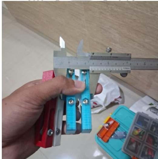
Gambar 4 - 7 Pengukuran ketinggian untuk penggunaan Height adjustment base
