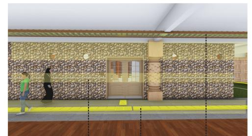
Hand rail Sepanjang dinding batas koridor Jalur Guiding Block Pencahayaan Butana Pada Plafon
