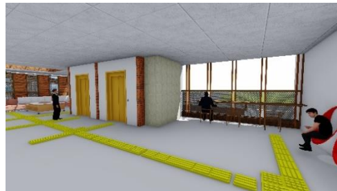
Gambar 4-39 Penerapan Guding Block Pada Interior Lobby
