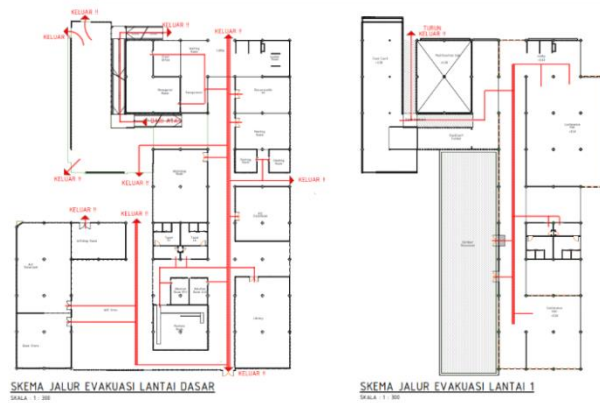
Gambar 4-34 Jalur Evakuasi Keselamatan Bangunan (Penulis,2017)
