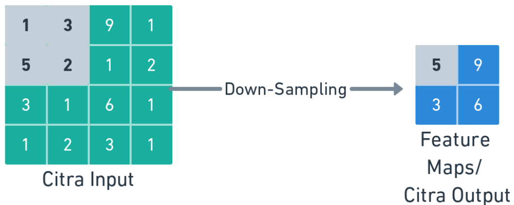
Gambar 2. 5 Proses Max-Pooling dengan Ukuran Kernel 3x3 dan Jumlah Strides 2
