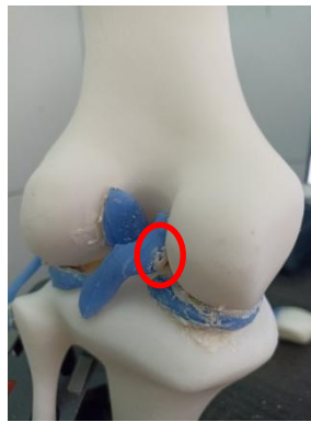
Gambar 4-51 Kegagalan pada perekat sealant .
