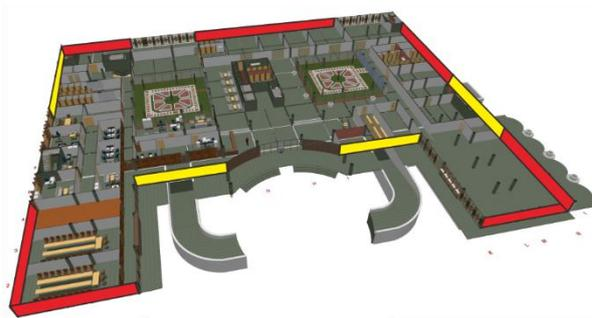
Penerapan material batu bata dalam rancangan dapat dilihat pada gambar 7.1, warna merah pada gambar menunjukkan pemasangan dinding bata expose sedangkan warna kuning menunjukkan pemasangan bata plester dengan finishing cat warna putih gading.
