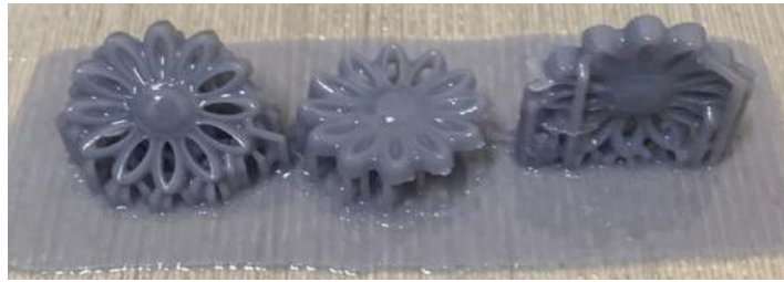
Gambar 4. 4 Hasil Pencetakan dengan tiga posisi
