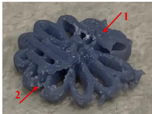
Gambar 4. 5 Kegagalan saat pelepasan support
