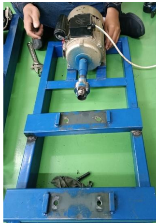
Gambar 3- 11 Pemasangan Motor Elektrik dan Kopling
