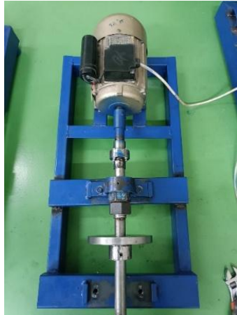
Gambar 3- 14 Pemasangan Beban Uji
