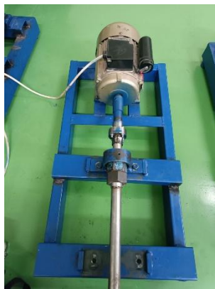
Gambar 3- 13 Pemasangan Mur Preload dan Poros
